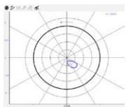
Orbit         | Überwachung von Wellenlage und Wellenbewegung | ↔ Konfiguration, Validierung und Detailanalyse |
