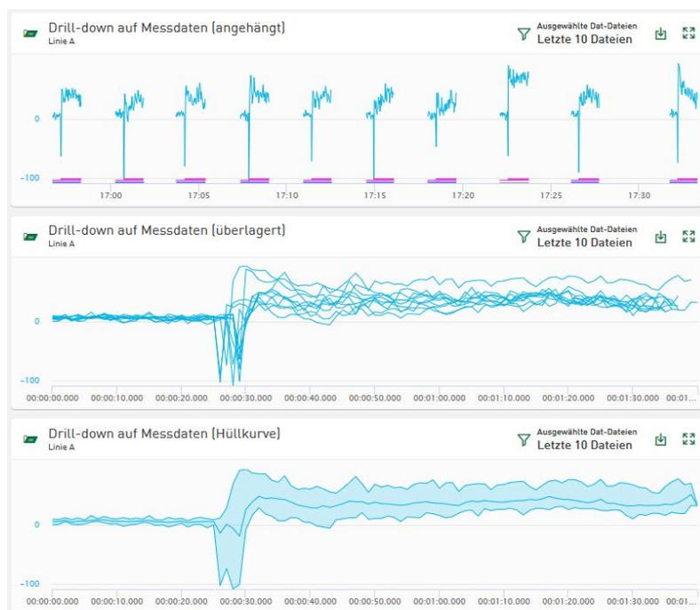
Mehrere Messdateien können aneinander gehängt (oben) oder in der überlagerten Ansicht (Mitte) direkt verglichen werden. In der Hüllkurvenansicht (unten) werden Maximal-, Mittel- und Minimalwerte als Trend angezeigt.
