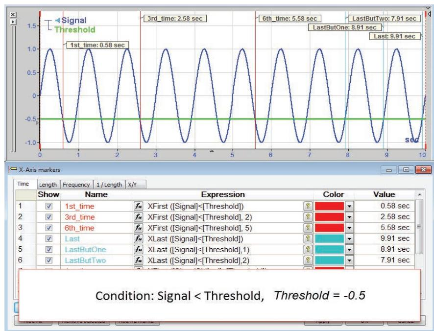
Пример: Обозначение позиций при помощи маркеров оси X, где значение сигнала в первый, третий и шестой раз опускается ниже -0,5 и в последний, предпоследний и предпредпоследний раз поднимается выше -0,5.
