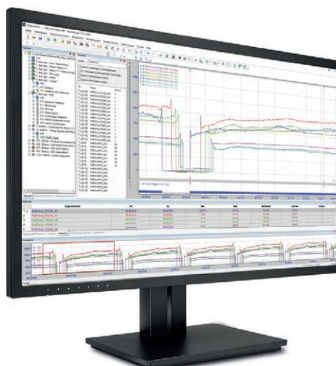
Sämtliche Teilfenster, wie Signalbaum, Signalstreifen, Wertetabelle, Suchdialog, etc. lassen sich frei anordnen. Mit Hilfe von Markern lassen sich Signalverläufe einfach und schnell vermessen
