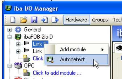
Если ibaPDA автоматически распознает устройство, то оно будет добавлено в дерево элементов со всеми подключенными к нему модулями.
