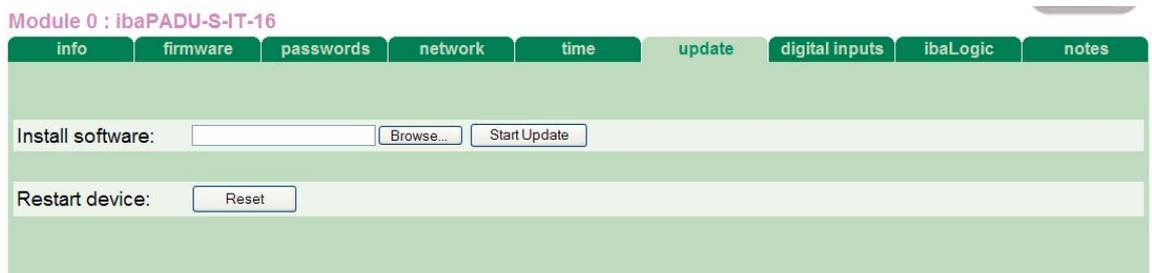
Рис. 26: Обновление посредством Web-интерфейса
